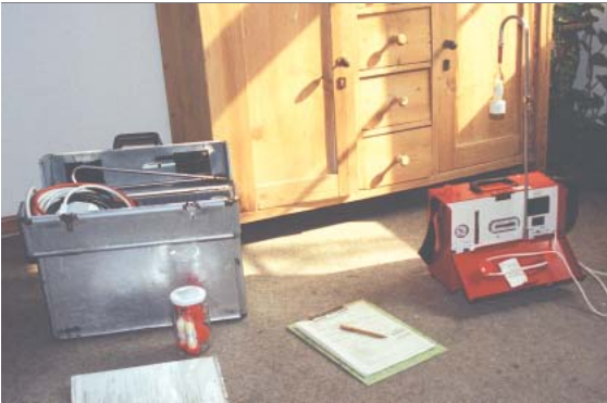
Bei Verdacht auf eine Schadstoffbelastung kann die Luft in der Wohnung gemessen werden.
